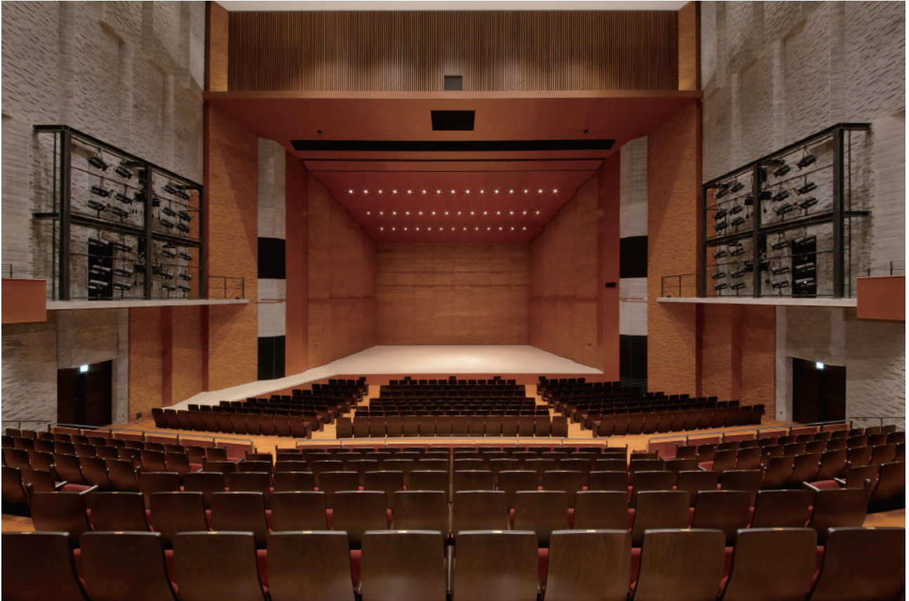
音響反射板を設置した舞台
