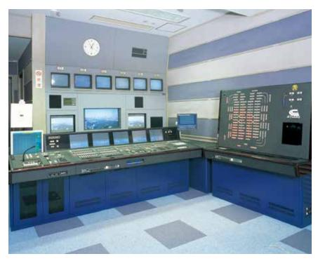
シューティング操作卓と、調光操作卓を組み合わせた総合制御卓です。調光操作卓からのキューリンクで、調光とシューティングを制御することができます。シューティング操作卓では、器具のパン・チルト・フォーカス・カラーチェンジ・バンドアのデータと、昇降バトンのデータをメモリすることができます。メモリされたデータを再生することにより、短時間で仕込みデータを再現できます。
