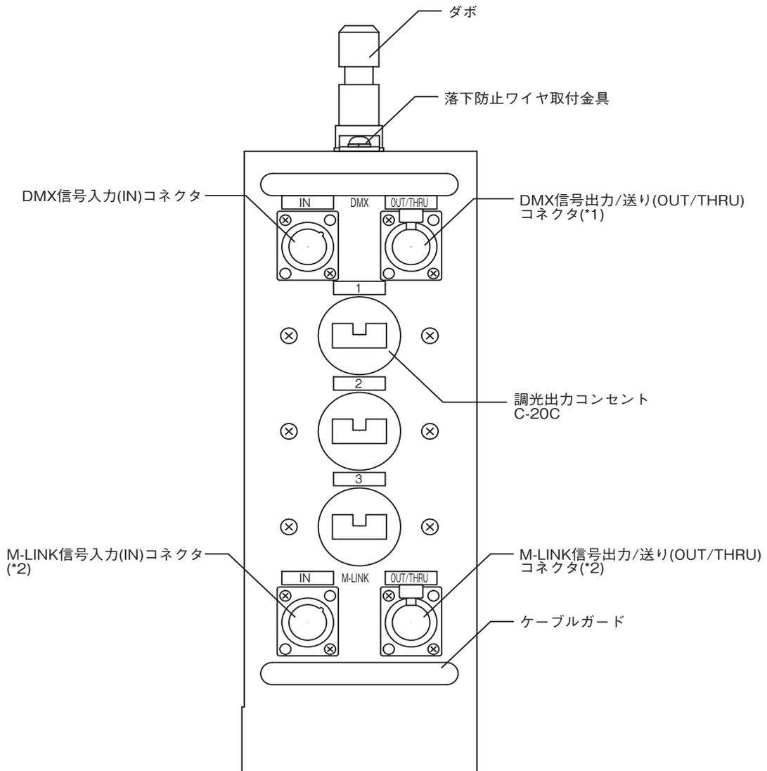
\* 1 : 本体通電時は、内部の信号ドライバ（アンプ）を通して出力されます。
