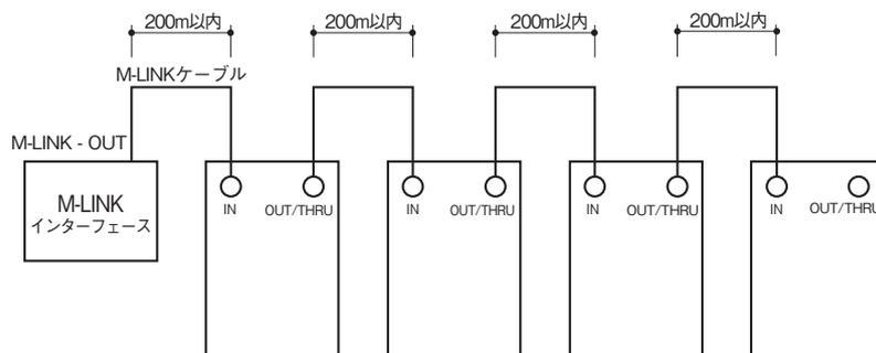
※ M-LINK 信号は、調光器アラームを外部に表示させる当社規格の信号です。別途に M-LINK インターフェースおよび表示装置が必要となります。
